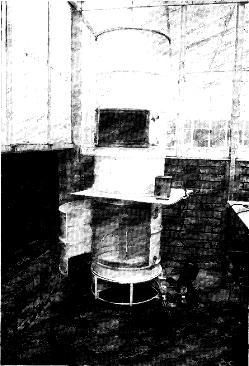
Figura 1. Partes esenciales de la torre modificada para inoculación de esporas de hongos: A. Cilindro; B. Lámina corrediza; C. Base giratoria; D. Tubo, a través del cual, fluye aire hacia la boquilla De Vilbiss; E. Manguera de conducción del inóculo, la cual va conectada a la boquilla De Vilbiss; F. Compresor de aire; G. Motor eléctrico; y H. Regulador de velocidad.
